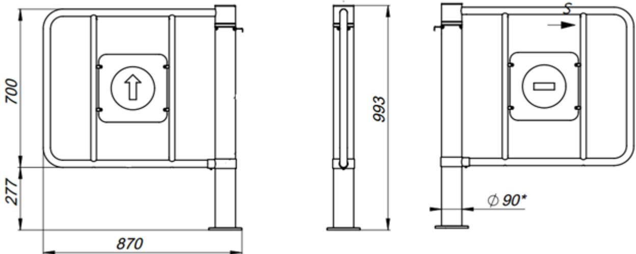
Рисунок 2 – Габаритные размеры калитки размером 870 мм
