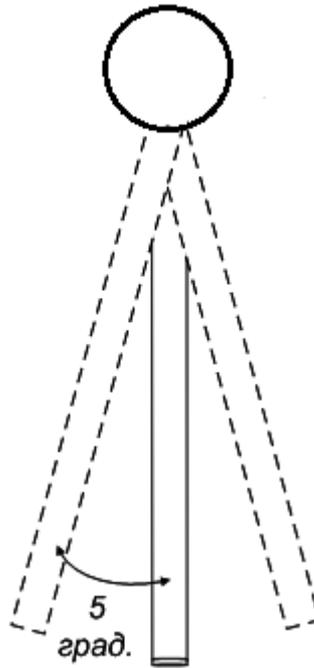
Рисунок 3 – Возможный свободный ход планки в режиме «STOP»
